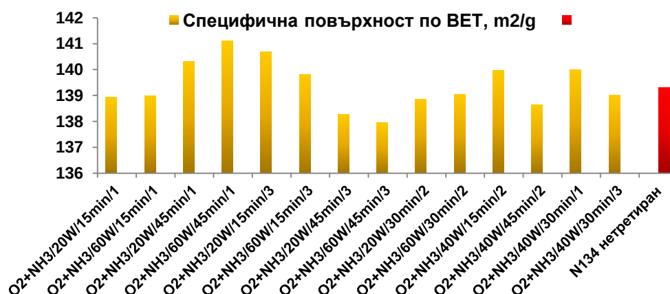
Фиг. 6. Специфична повърхност по BET на третираните с кислородна плазма образци от N134 при условия съгласно оптималния композиционен план(в дис. 5.17).
