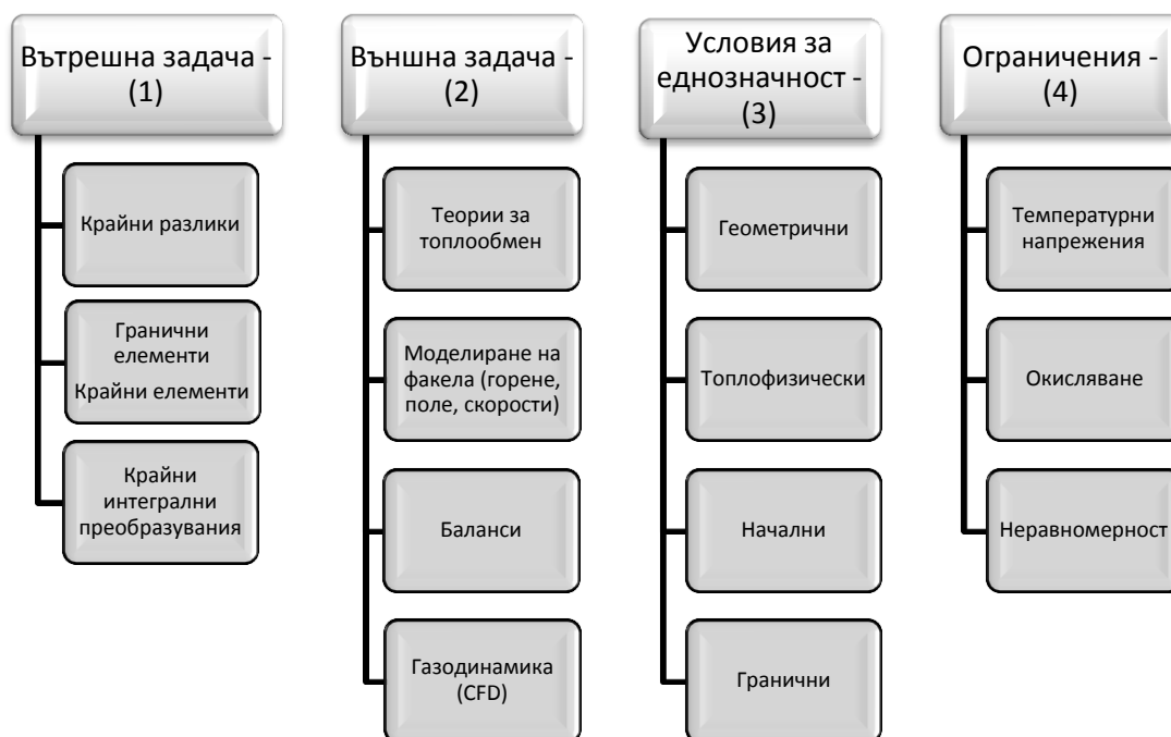
Фиг.5.1: Структура на модел на топлинните процеси в металургични нагревателни агрегати
