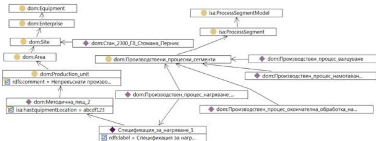
Фиг.4.4: Класове „Процесни сегменти“ и „Оборудване“ в домейн онтологията на производство горещо валцуване, показани в Graph Panel в TopBraid Composer Maestro Edition
