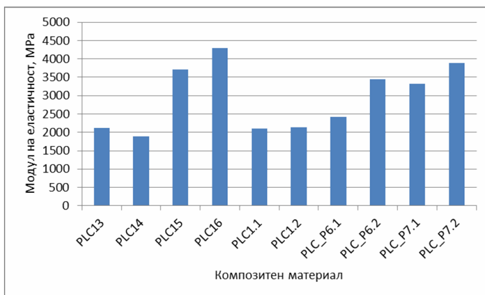
Фиг.31 Модул на еластичност на ДПК при триточково огъване
