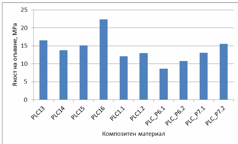
Фиг.30 Якост на огъване на ДПК
