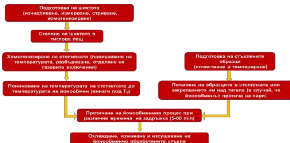
Фигура 4. Принципна схема на йонообменния процес
