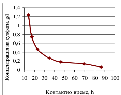
Фигура 23. Влияние на контактното време върху остатъчната концентрация на сулфати при захранване на анаеробния биореактор с хранителна среда, съдържаща сулфати – 3 g/l и \text{TOC}/\text{SO}_4^{2-} - 1.1
