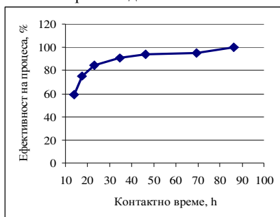
Фигура 22. Влияние на контактното време върху ефективността на процеса при захранване на анаеробния биореактор с хранителна среда, съдържаща сулфати – 3 g/l и \text{TOC}/\text{SO}_4^{2-} - 1.1
