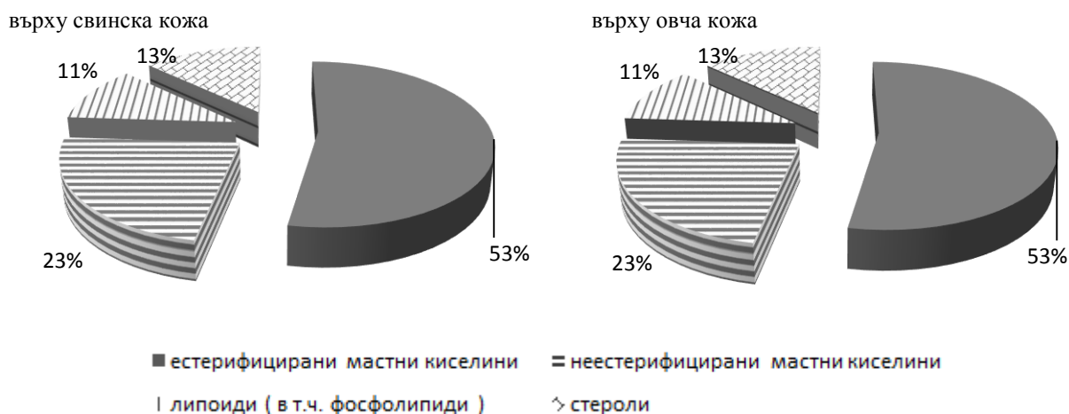
Фиг. III.1 Масови части в % на вида на разпадните продукти в отпадъчния разтвор след действието на lipase BVP
