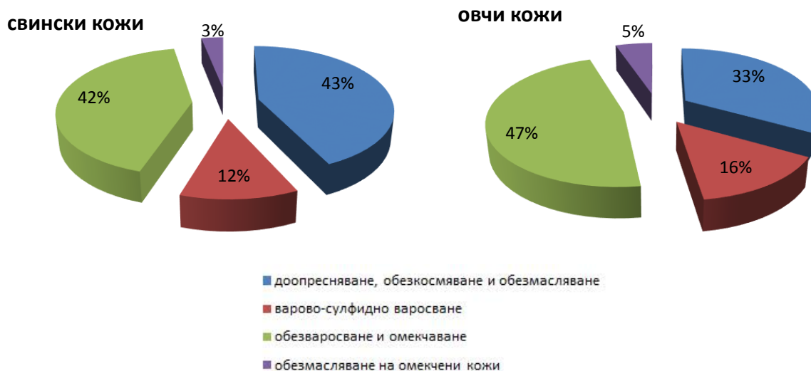
фиг. III.15. Масови части в проценти на извлечени мазнини при ензимна преддъбилна обработка за свински и овчи кожи
